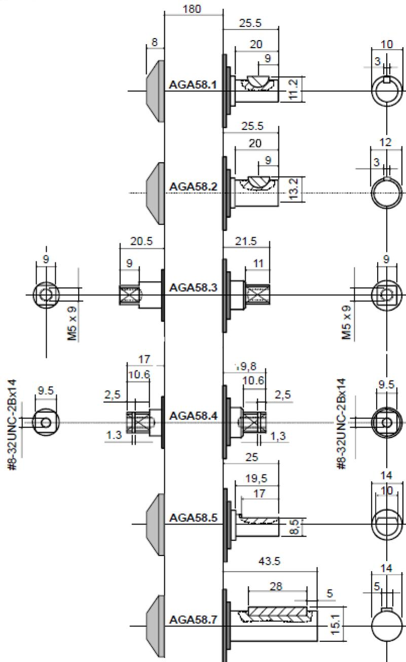
**Figure 31. Shaft Dimensions.**
